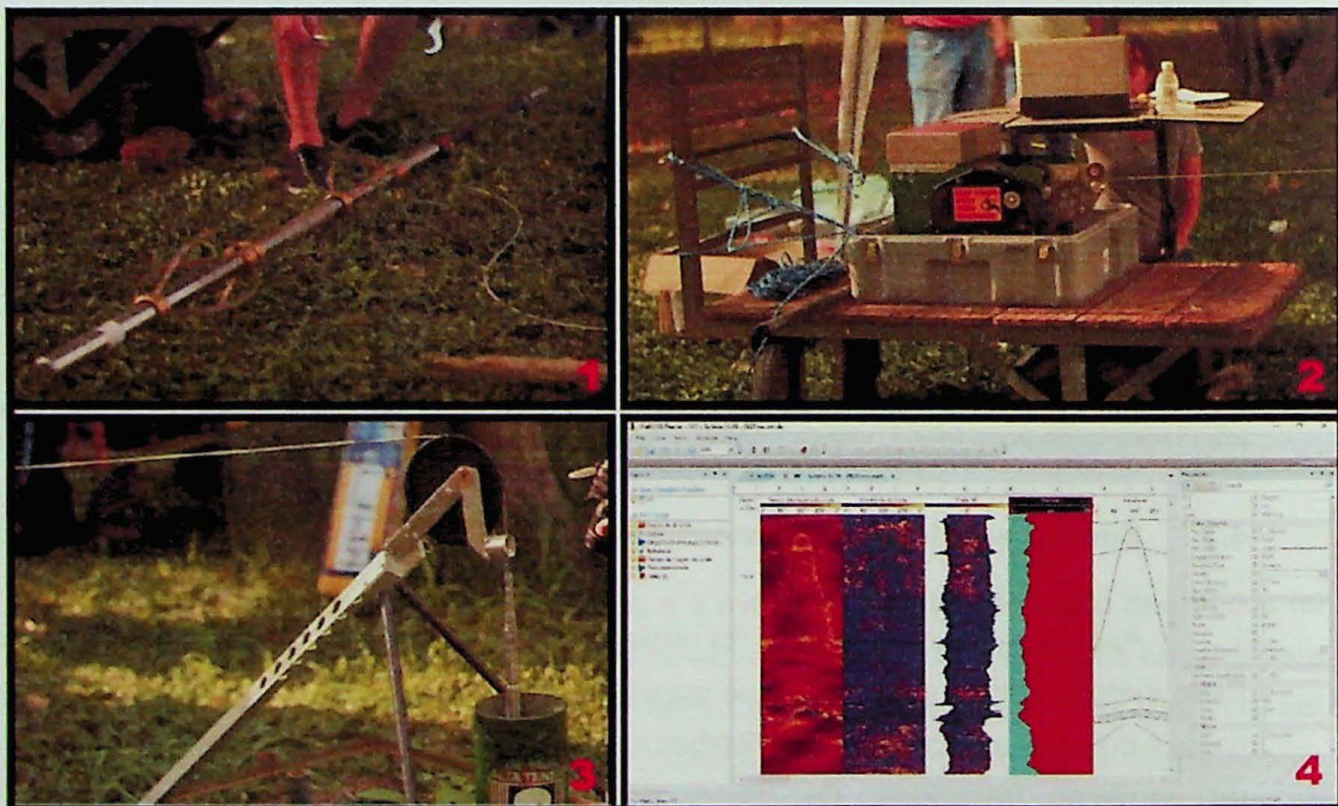
Figura 8: 8.1 – sonda de televisionamento acústico com os dois centralizadores; 8.2 – guincho com data logger acoplado; 8.3 – tripé e cabo de sustentação/transmissão; 8.4 – plataforma do software WellCad. (Fotos 8.1, 8.2 e 8.3 por Ana Paula de Andreis, ECA-USP).
