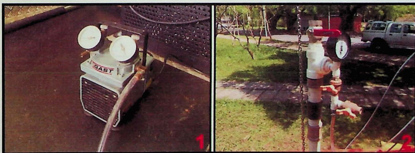
Figura 12: 12.1 – bomba de pressão e vácuo; 12.2 – conexão selante com válvulas para controle da pressão e vácuo manômetro acoplado.
