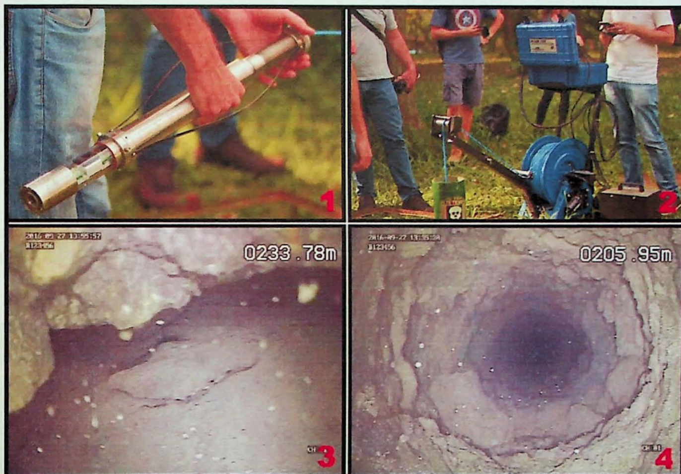
Figura 7: 7.1 – câmera de filmagem para poço com detalhe das visadas frontal e lateral; 7.2- guincho operador da câmera; 7.3 – foto de fratura na parede do poço PP-01 (visada lateral); 7.4 – foto de zona com afunilamento do poço PP-01 (visada frontal). (Fotos 7.1 e 7.2 por Ana Paula de Andreis, ECA-USP).
